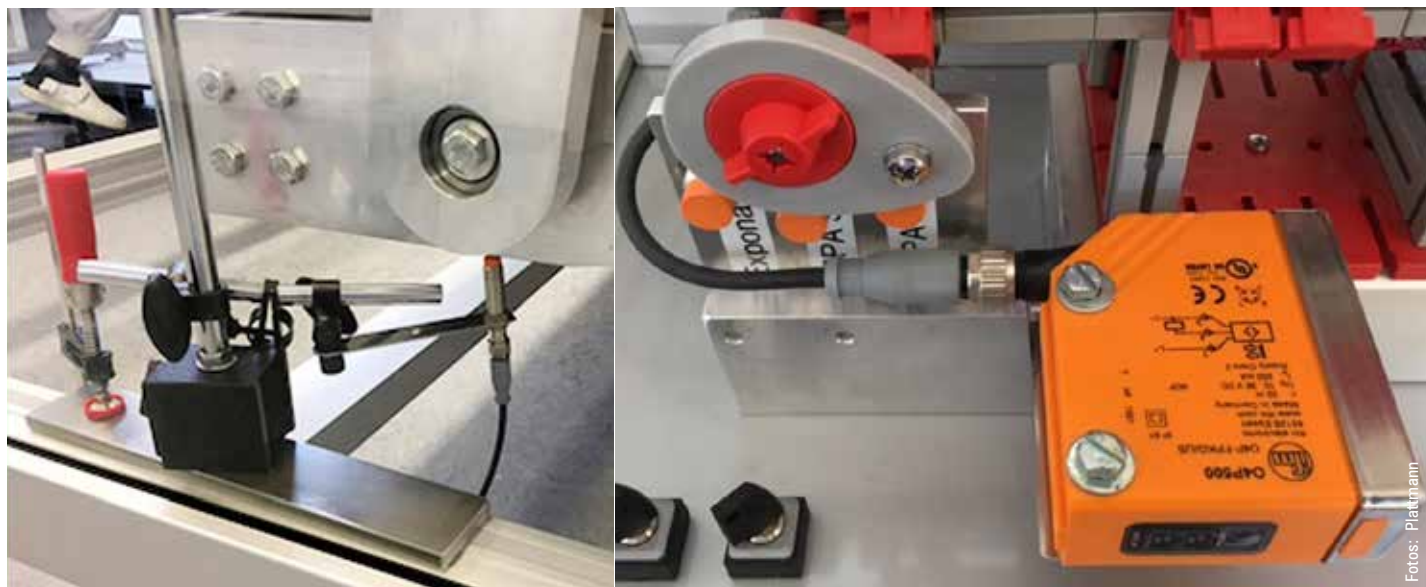
Sensoren und Lichtschranken lassen sich einfach und auch zur temporären Nutzung installieren.
